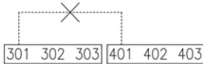
**Примечание 2.** Любой тип электрического соединения между этими двумя группами клемм запрещен, иначе контроллер может сгореть!
